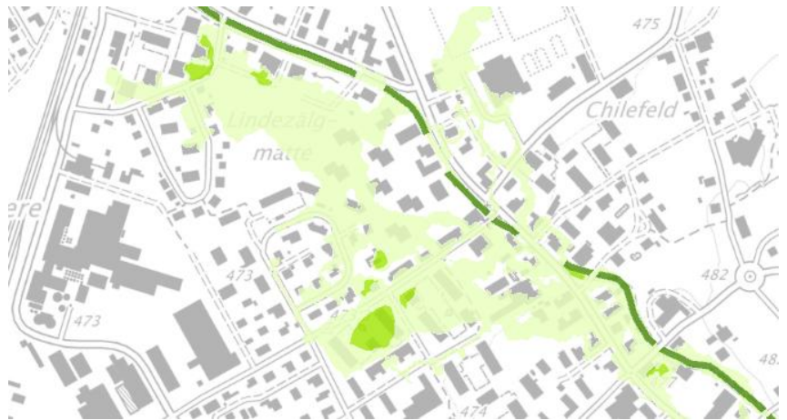
Abbildung 28: Ausschnitt aus der Intensitätskarte, Gefahrenprozess Wasser, Ortsteil Dagmersellen
