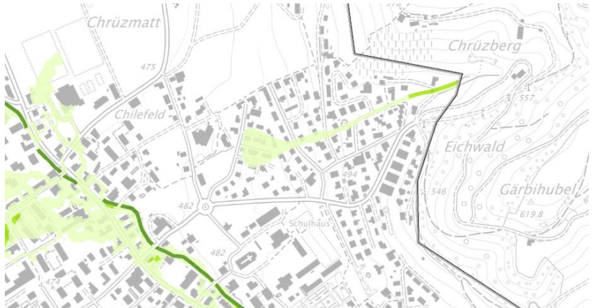
Abbildung 24: Ausschnitt aus der Intensitätskarte, Gefahrenprozess Wasser. Schwachstellen entlang des Gerinnes: Eindolungen Kote 523 und Kote 515 (siehe Abb. unten). Quelle: technischer Bericht zur Gefahrenkarte.
