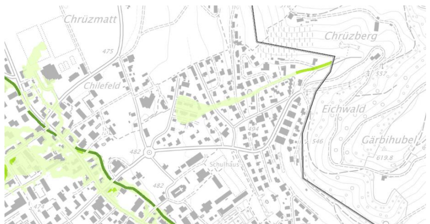
Abbildung 6: Ausschnitt aus der Intensitätskarte, Gefahrenprozess Wasser. Schwachstellen entlang des Gerinnes: Eindolungen Kote 523 und Kote 515 (siehe Abb. unten). Quelle: technischer Bericht zur Gefahrenkarte
