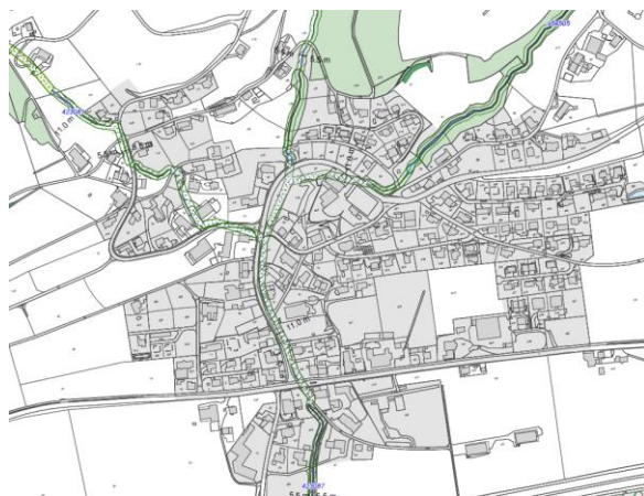
Abbildung 22: Ausscheidung des Gewässerraums entlang des eingedolten Abschnitts
